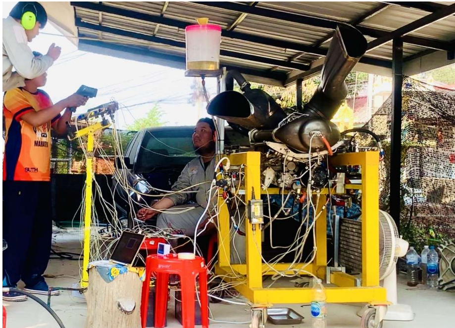
รูปที่ 3.10 การสตาร์ทเครื่องยนต์เทอร์โบชาร์พด้วยระบบเดิม(ไม่มีโหลด)
