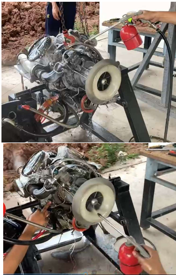
รูปที่ 3.5 ทำความสะอาดเครื่องยนต์ และ Compressor
