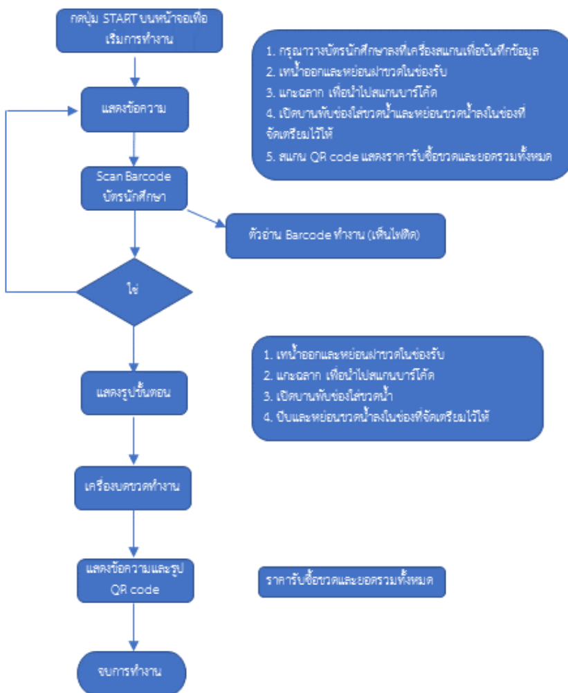
รูปที่ 10 ผังการทำงานของเครื่องรับซื้อและบดย่อยขวดพลาสติก
