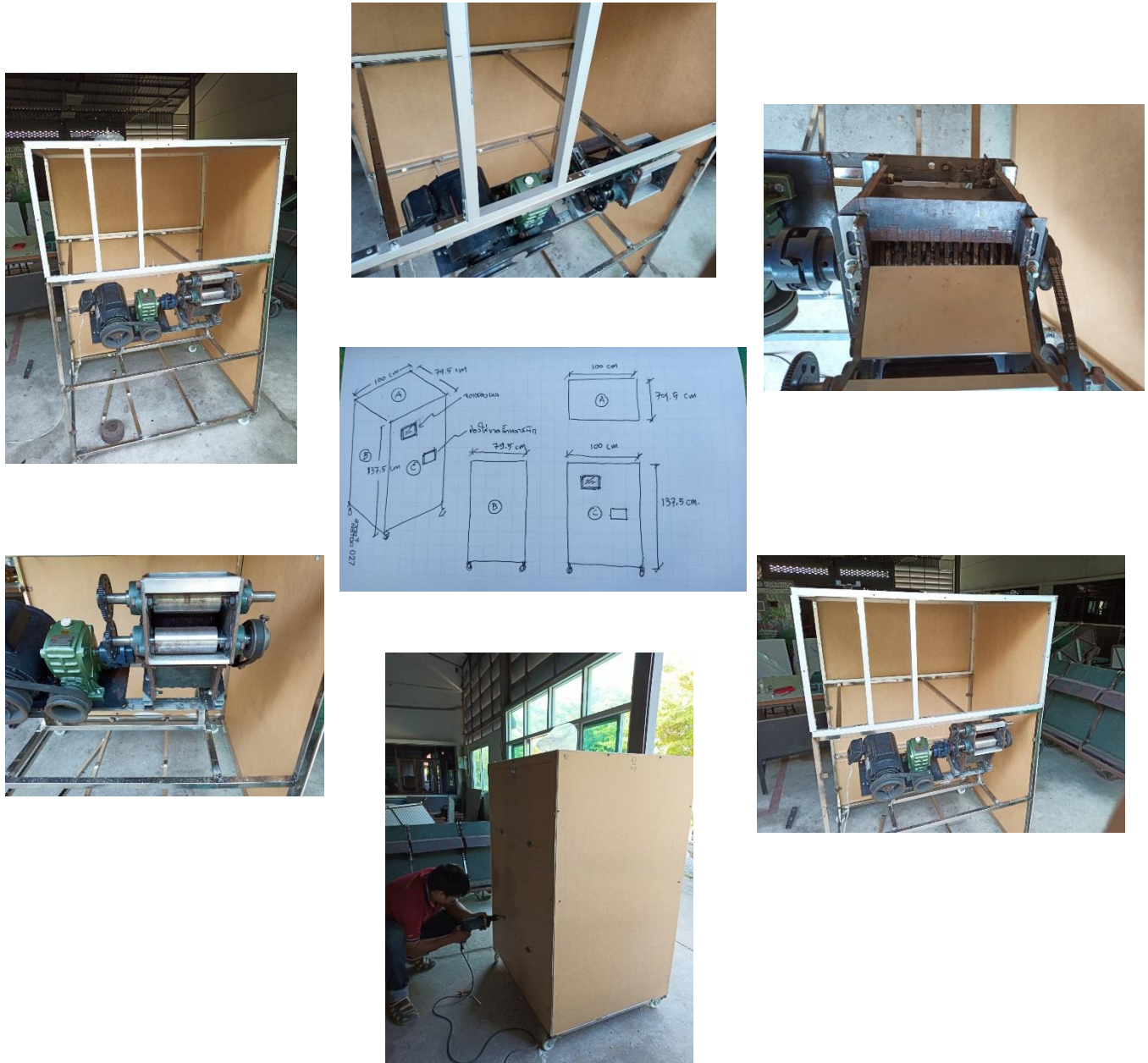
รูปที่ 8 การสร้างเครื่องรับซื้อขวดฯ ภายในห้องปฏิบัติการวิจัยและพัฒนาเครื่องจักรกล ฟาร์มมหาวิทยาลัยเทคโนโลยีสุรนารี
