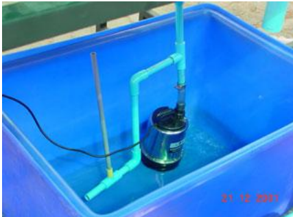
ส่วนประกอบในถังขนาด 200 ลิตร มีท่อแยกเพื่ออัดออกซิเจนลงไปในน้ำ
